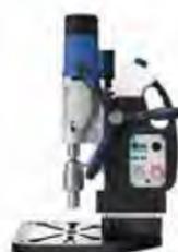
Con el dispositivo de sujeción móvil MobilCLAMP se amplían las posibles aplicaciones de una taladradora de núcleo magnética en el montaje y en el taller. La taladradora de núcleo magnética se ubica sobre una superficie de colocación y se enciende. Los componentes se pueden fijar con seguridad en el tornillo de banco de prisma, sin mucho esfuerzo dispondrá de una taladradora de mesa flexible.
