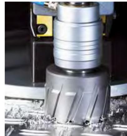
BDS fabrica brocas huecas en modernos centros de rectificación controlados por CNC, lo cual garantiza un rectificado uniforme, calidad y rendimiento en el corte de todas las herramientas de taladrado en todo el abanico del programa.
